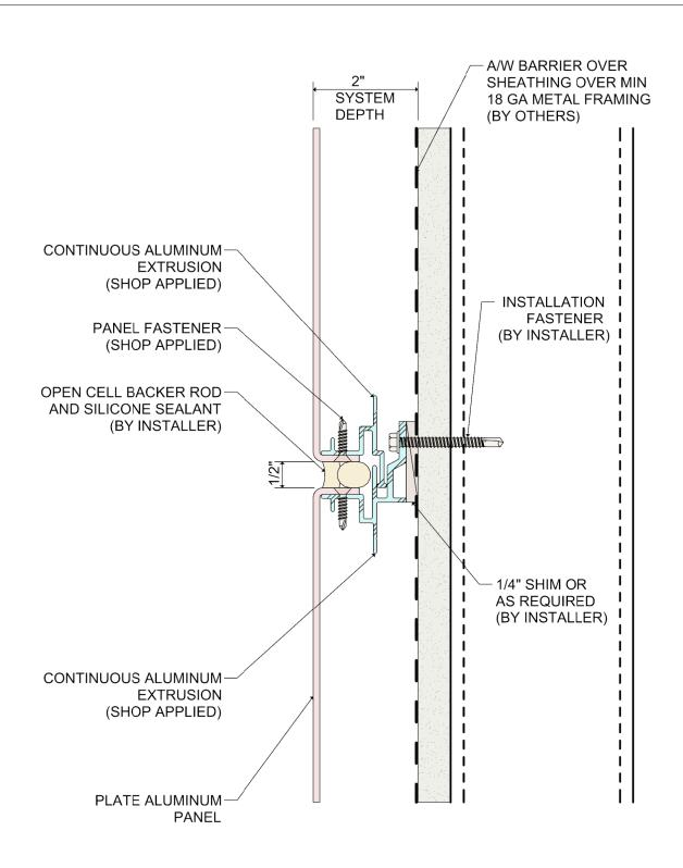
DETAIL: SYSTEM 3150 WET SEAL SYSTEM
