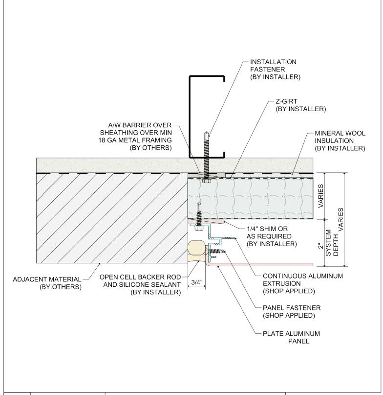
WET SEAL SYSTEM **SYSTEM 3150** DETAIL: VERTICAL JAMB DETAIL
