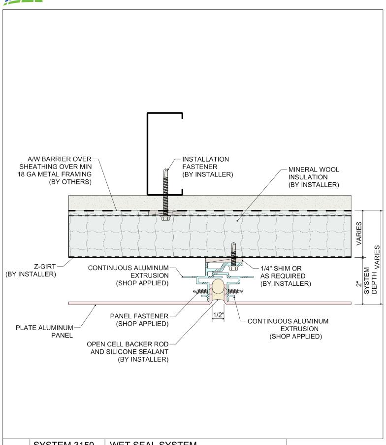
DETAIL: SYSTEM 3150 WET SEAL SYSTEM
